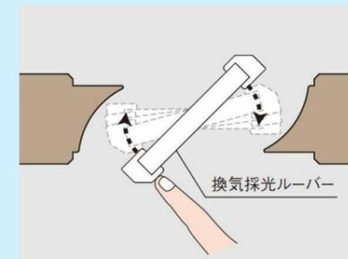
「換気採光ルーバー」を指で押して閉じた際、ダンパー機構によりゆっくりと閉まります。
